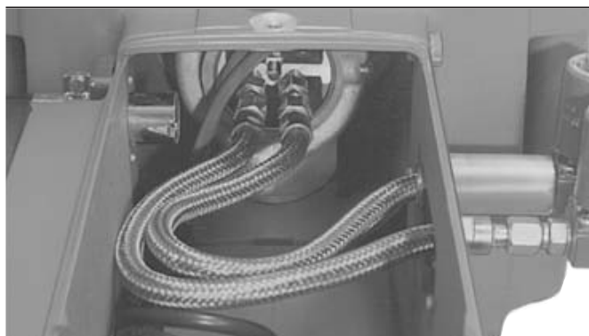
Демонтаж форсуночного блока и крепления электродов
