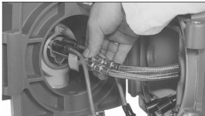
Демонтаж смесительного корпуса
