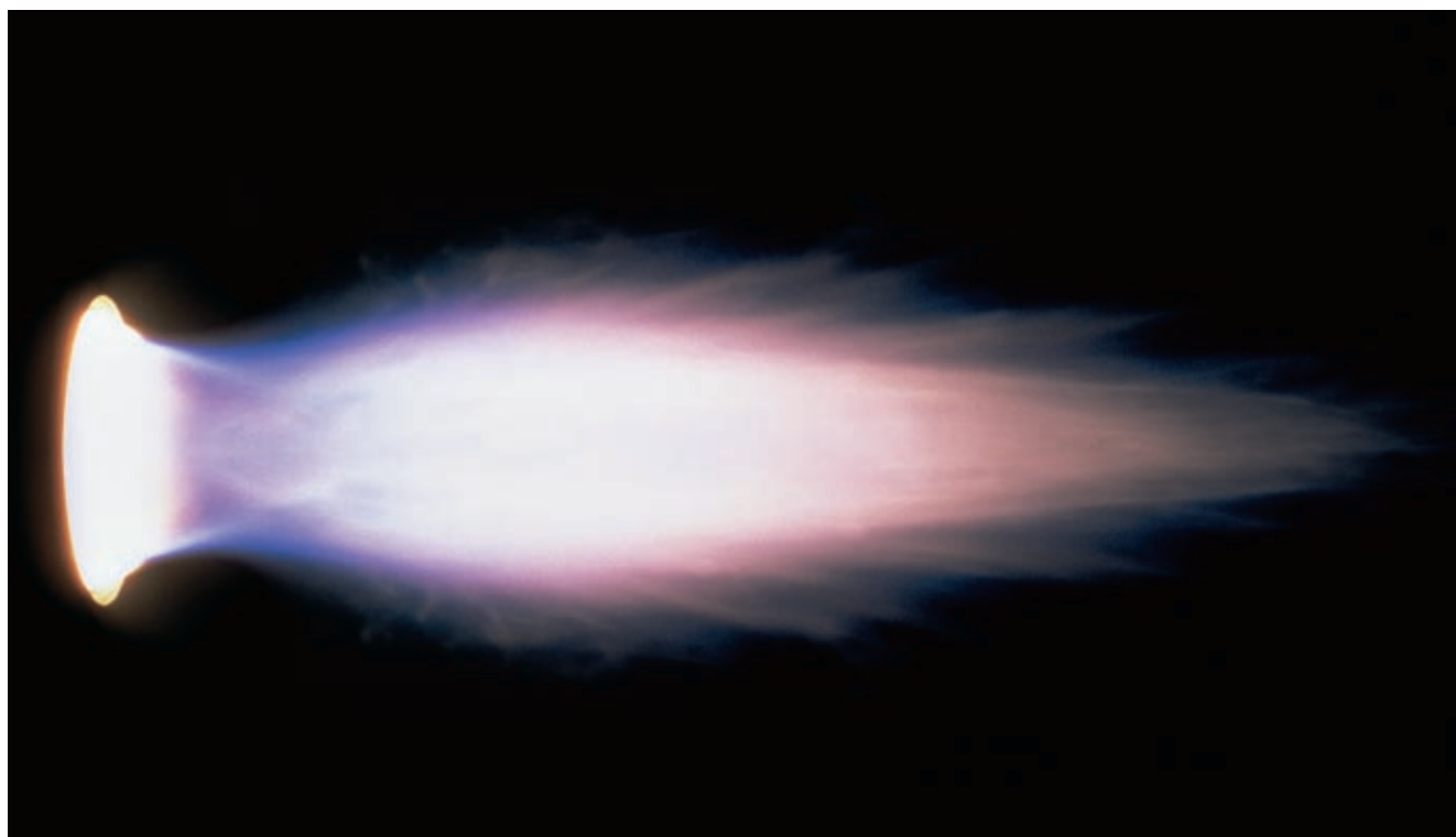
Типичный рисунок пламени жидкотопливных горелок в исполнении LN (LowNOx) (с низким содержанием \text{NO}_x в дымовых газах).
