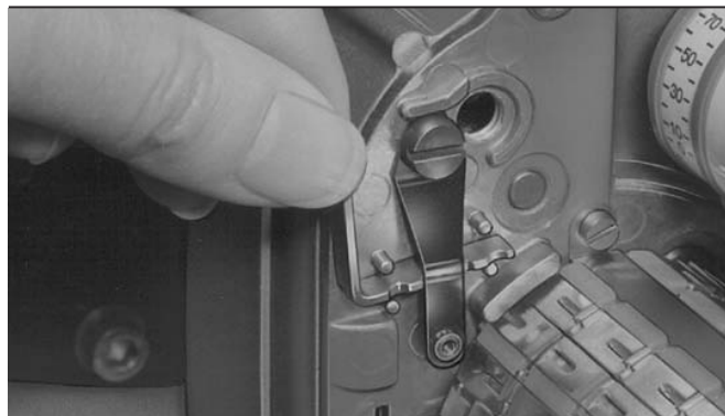
Расцепление сервопривода 1055/80
